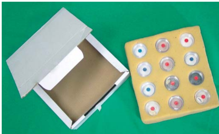
Figura H.1 Caixa de papelão contendo espuma com cortes circulares no tamanho do porta-filtro de coleta
