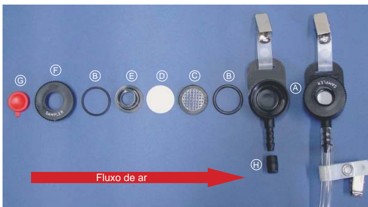
Figura E.5 Dispositivo de coleta tipo IOM para particulado inalável
